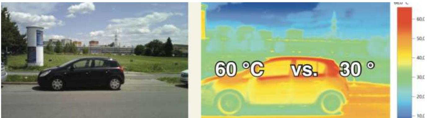
Abbildung 5: Aufnahme Wärmebildkamera Auto | Unterschied Oberflächentemperatur
