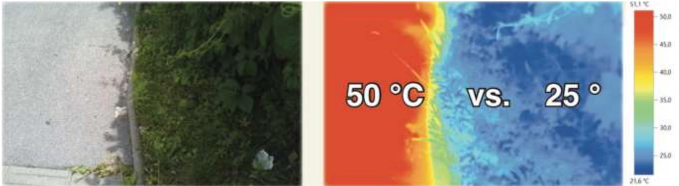
Abbildung 4: Aufnahme Wärmebildkamera Gehweg/Prototyp Schaugarten Wiese | Unterschied Oberflächentemperatur
